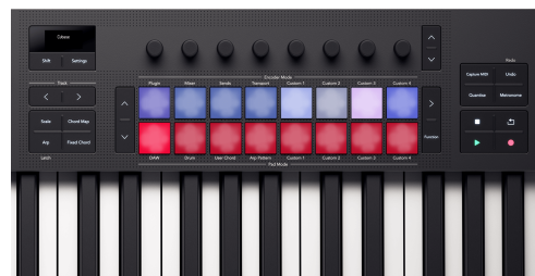
De Launchkey 61 pads die de status van de trackselectie en opnamearm op de pads weergeven.
