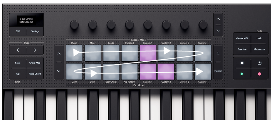
Pad-indeling met pijlen die de richting van de sequencer aangeven
