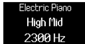
Regel de frequentie van de High Mid-EQ-band met encoder 5.
