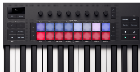
The Launchkey 61 spilventiņi, kas atspoguļo trases atlasīšanu un ieraksta roku stāvokļus uz spilventiņiem.
