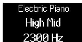
Controllo della frequenza della banda High Mid-EQ con l'encoder 5.
