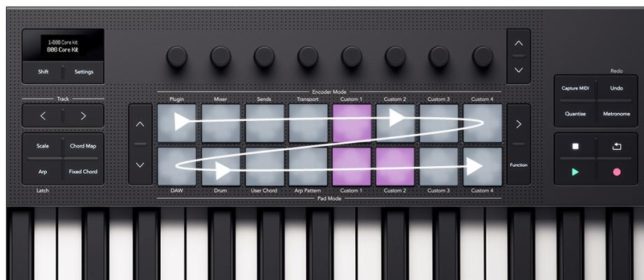
Layout del pad con frecce che mostrano la direzione del sequenziatore
