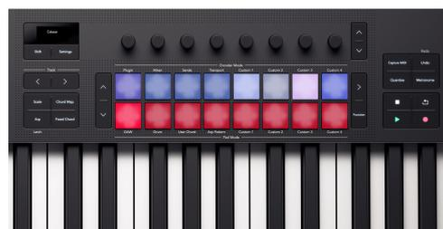
I pad Launchkey 49 che riflettono gli stati di selezione della traccia e armatura per la registrazione sui pad.
