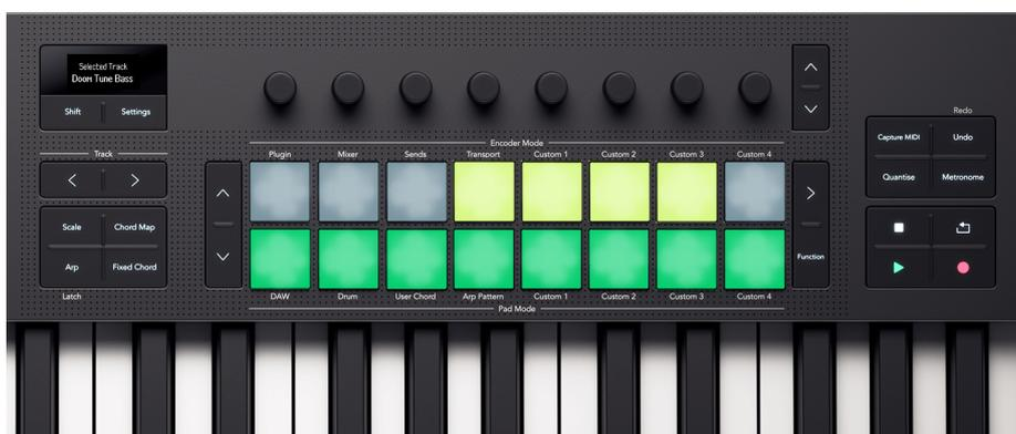
La riga inferiore del pad Launchkey 49 attiva le scene Live Loops di Logic.
