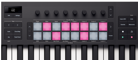
Ten Launchkeypady reprezentujące nuty w sekwencerze.
