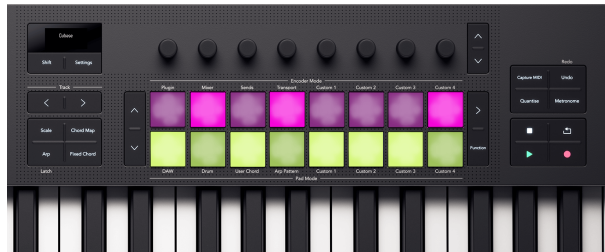
Ten Launchkey 49 pady odzwierciedlające stany wyciszenia i solo miksera na padach.
