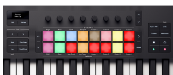
Ten Launchkeypady pokazujące klipy, które możesz wybrać. Puste gniazda klipów świecą na czerwono.
