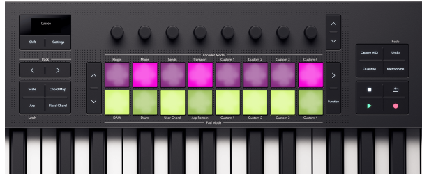
De Launchkey 49 pads som gjenspeiler mikseren Mute og Solo-tilstander på pads.
