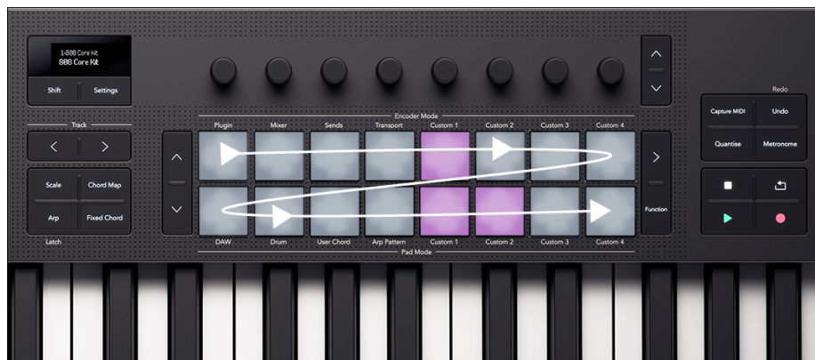
Diseño del pad con flechas que muestran la dirección del secuenciador
