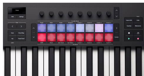
Los pads del Launchkey 49 que reflejan la pista seleccionada y pasan al estado de armado para la grabación en los pads.
