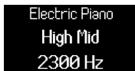
Control de la frecuencia de la banda de ecualización media alta con el codificador 5.
