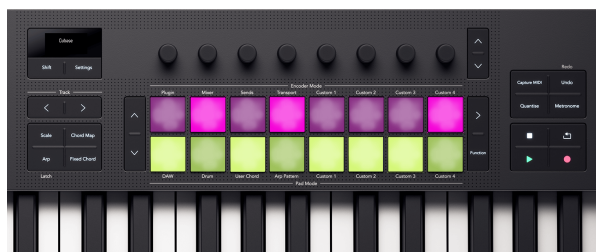
Launchkey 37 のパッドに、Cubase のミュート/ソロのステータスが反映されている様子。
