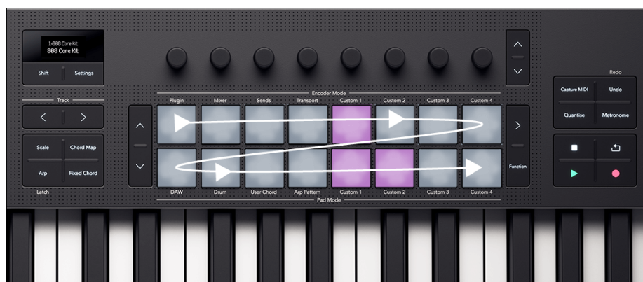
Pad-layout med pilar som visar sequencerns riktning
