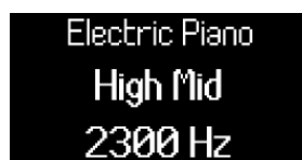
Styrning av High Mid-EQ-bandets frekvens med kodare 5.
