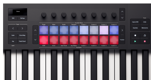
De Launchkey 37 pads die de status van de trackselectie en opnamearm op de pads weergeven.
