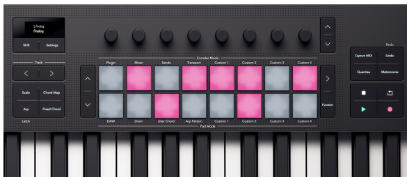
De Launchkey's pads die de noten in de sequencer voorstellen.
