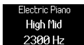
Kõrge-keskmise ekvalaiseri sagedusriba reguleerimine kodeerijaga 5.
