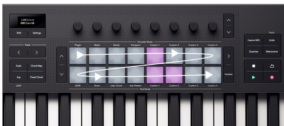
Pad layout med pilar som visar riktningen för sequencern
