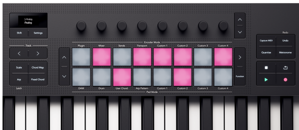
De Launchkeys pads som representerar tonerna i sequencern.
