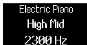
Controlul frecvenței benzii High Mid-EQ cu codificatorul 5.
