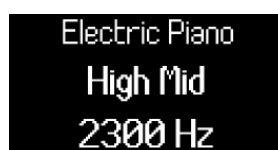
Sterowanie częstotliwością pasma High Mid-EQ za pomocą enkodera 5.
