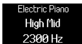
Regel de frequentie van de High Mid-EQ-band met encoder 5.
