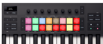
I pad di Launchkey che mostrano le clip che è possibile selezionare. Gli slot vuoti delle clip si illuminano di rosso.
