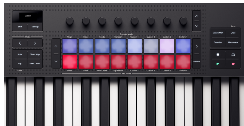
Launchkey 25 のパッドに、Cubase の選択トラックと録音アーム状態が反映されている様子。
