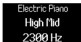
Ovládanie frekvencie pásma vysokých a stredných tónov ekvalizérom pomocou enkodéra 5.
