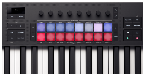
The Launchkey 25 pady odrážajúce výber stopy a zaznamenávanie stavov ramena na padoch.
