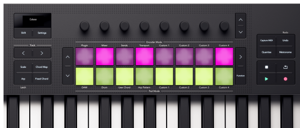
Los pads del Launchkey 25 que reflejan los estados Silencio y Solo del mezclador en los pads.
