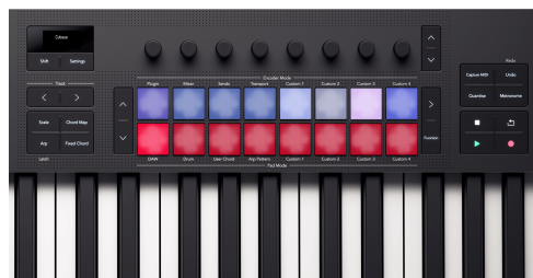
Ten Launchkey 25 pady odzwierciedlające stany ramienia wyboru ścieżki i nagrywania na padach.
