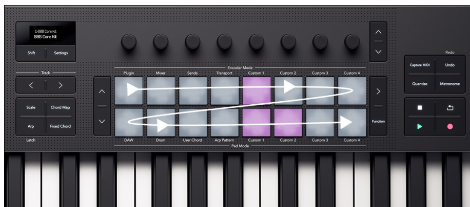
Layout dos pads com setas mostrando a direção do sequenciador
