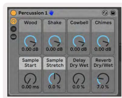
Se a Trilha não tiver um Rack, o Device Mode será sincronizado com uma seleção de oito parâmetros escolhidos do primeiro dispositivo. Para navegar entre dispositivos numa trilha que contém vários, veja 'Device Select/Lock'.
