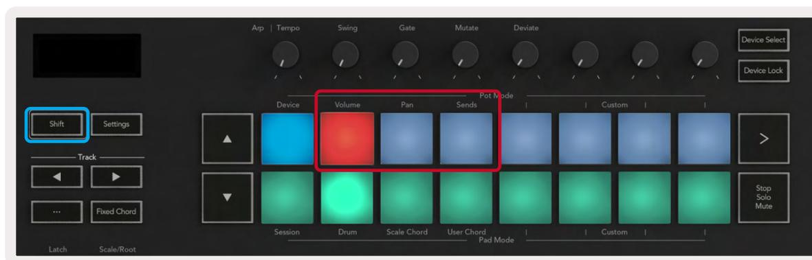
**Volume** - Esse modo permite controlar o volume do Track usando os potenciômetros. Para selecionar esse modo, segure o botão Shift e pressione o pad Volume.
