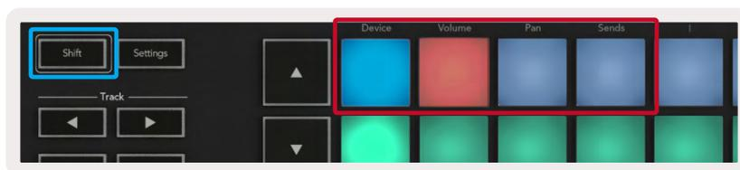
**Device Mode** - Vincula os potenciômetros aos parâmetros, ou “controles inteligentes” do dispositivo na trilha selecionada. Para trilhas de instrumentos, esta é a matriz de parâmetros do instrumento. Para atribuir os potenciômetros ao Device Mode, pressione o Device Pad (canto superior esquerdo) com o botão Shift pressionado. Agora, quando você move um potenciômetro, o parâmetro do dispositivo alterado e seu valor atual são exibidos na tela por um momento.
