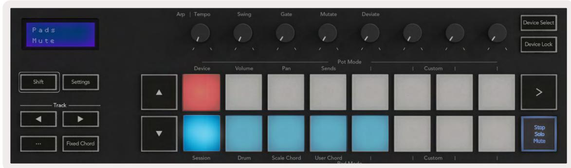
Você pode alternar entre os dois modos Record/Solo pressionando o botão Stop/Solo/Mute. Observe que ao usar o Launchkey com o Logic Pro, o botão Stop/Solo/Mute apenas alternará entre os modos Solo e Mute, não há modo Stop. O botão **Stop transport** interrompe a reprodução.
