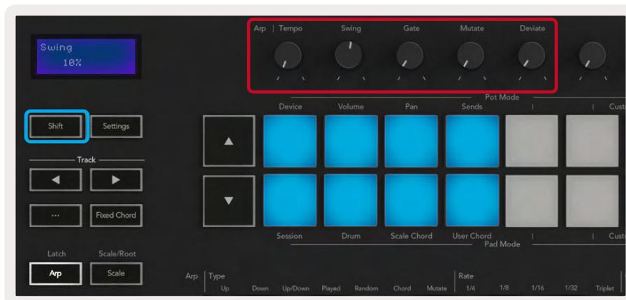
**Tempo** – Este botão acelera ou desacelera seu arpejo em relação ao [Arp Rate](#). Usando o Launchkey como um controlador autônomo, esse tempo varia de 60 BPM a 187 BPM. No entanto, quando sincronizado com o Ableton Live, este botão não terá efeito.
