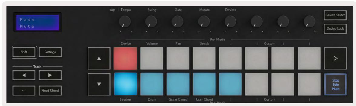
위의 두 모드는 중지/솔로/음소거 버튼을 눌러 전환할 수 있습니다. Launchkey를 Logic Pro X와 같이 사용할 때는 중지/솔로/음소거 버튼으로 솔로와 음소거 모드로만 전환할 수 있으며, 중지 모드는 없습니다. **트랜스포트 버튼을 누르면** 재생이 중지됩니다.
