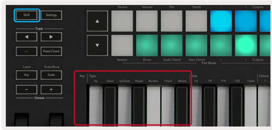
**Up(위로)** - 노트가 오름차순으로 연주됩니다(즉, 음높이가 증가함). 노트가 추가되면 시퀀스의 노트 수가 증가하지만 오름차순으로 유지됩니다. 예를 들어, 첫 번째 음표(E3)를 누른 상태에서 C3 및 G3 노트를 빠르게 추가할 수 있습니다. 그 결과 아르페지오는 C3, E3 및 G3가 됩니다.
