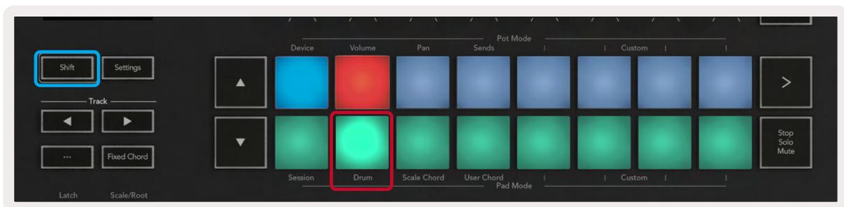
Drum Rack(드럼 랙)이 선택된 Live 트랙에 로드되고 Launchkey가 드럼 모드인 경우, 패드의 트랙 색에 불이 켜집니다. 이 패드는 연주될 때 녹색 불이 켜지고, 사용자 컴퓨터 화면에 보이는 모든 드럼 랙 패드를 연주합니다.▲▼버튼을 누르면 드럼 랙의 128개 패드 बैं크를 위/아래로 스크롤합니다. 버튼을 한번 누를 때마다 16개 패드로 구성된 बैं크 단위로 위/아래로 움직입니다.
