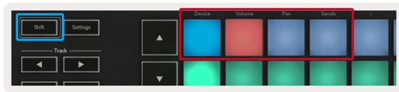
**장치 모드** - 선택된 트랙에서 포트를 장치의 파라미터 또는 '스마트 제어'로 연결합니다. 인스트루먼트 트랙에서는 악기의 파라미터 배열을 의미합니다. 포트를 장치 모드로 지정하려면 시프트 버튼을 누른 상태에서 장치 패드 버튼(왼쪽 위)을 누릅니다. 이제 포트가 움직이면 변경된 장치 파라미터와 그 현재 값이 화면에 표시됩니다.
