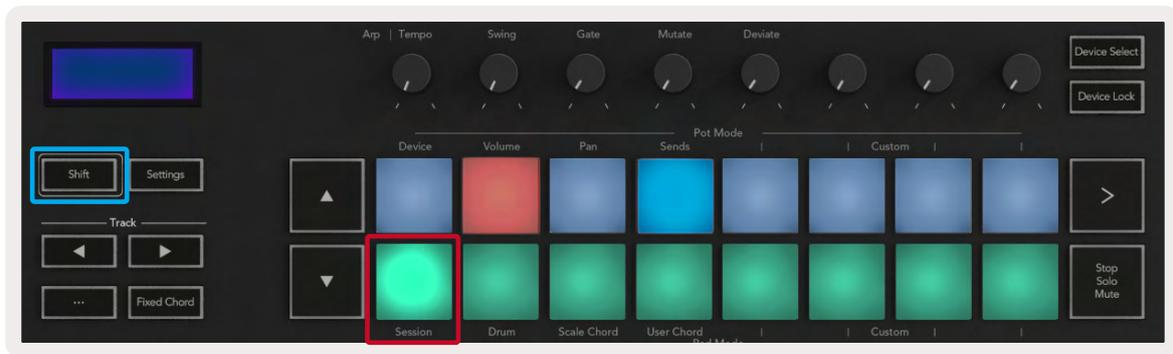
**녹음/음소거 모드** - 패드 맨 윗줄은 해당 트랙의 레코드 암을 켜고 끌 수 있으며 빨간색 불이 켜집니다. 패드 맨 아랫줄은 트랙 음소거를 켜고 끌 수 있으며 노란색 불이 켜집니다. 패드가 표시하는 트랙은 전송 트랙을 포함하며, 패드 맨 윗줄은 버스로 전송시 불이 들어오지 않습니다.
