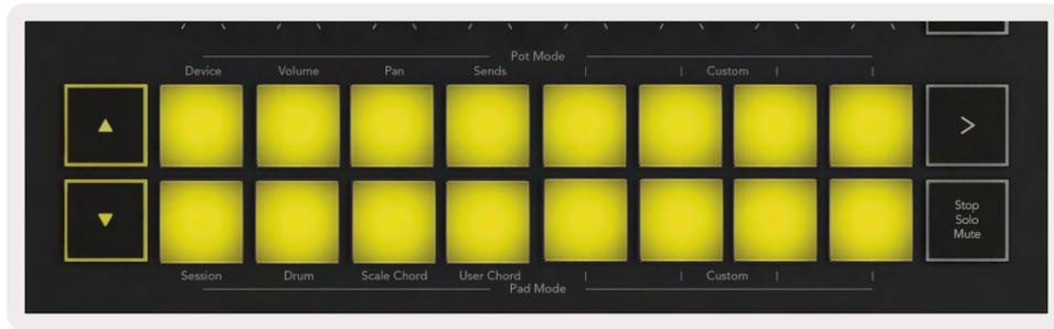
Ableton의 드럼 랙을 사용할 경우, 드럼 모드는 - 트리거 사운드와는 별도로 - 드럼 랙 내에서 관련 드럼 랙 패드를 선택합니다. 즉, 손을 떼면 마지막으로 연주된 드럼 랙 패드에 흰색 불이 켜지고, 선택된 드럼 랙 패드가 Ableton Live 화면에 표시됩니다.
