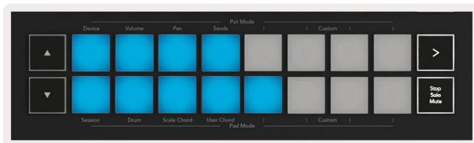
Para eliminar una asignación de acordes de un pad, mantenga presionado el botón de parada/solo/silencio, los pads con acordes asignados se volverán rojos. Presione un pad rojo para eliminar el acorde asignado, una vez eliminado, el pad ya no
