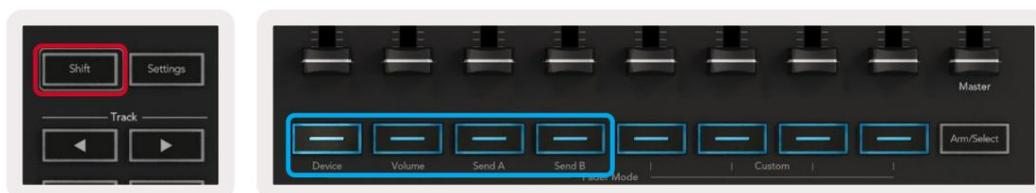
Nota: no puede asignar un modo tanto a los potenciómetros como a los faders al mismo tiempo. Si un modo ya está mapeado a los potenciómetros, entonces el botón Fader respectivo aparecerá en rojo mientras se mantiene presionada la tecla Shift, presionando un El botón Fader mientras está en este estado no asignará los faders a ese modo.
