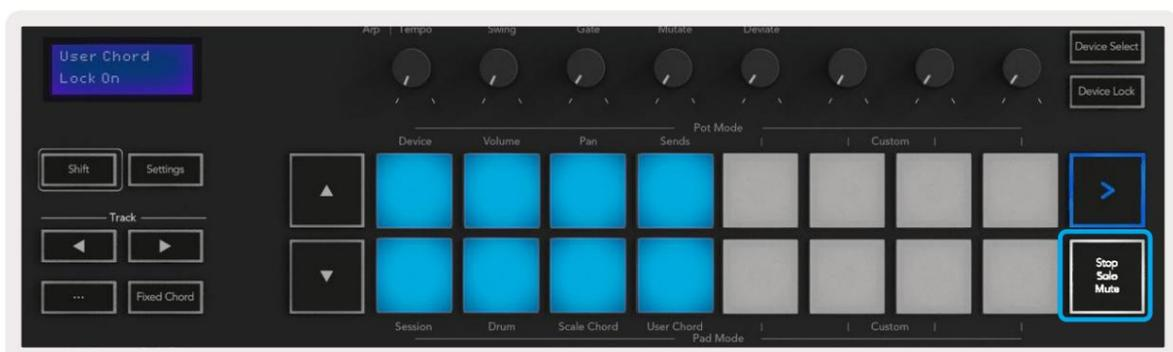
Puede usar los botones **↑** y **↓** para transponer el banco de acordes en semitonos entre -12 y +12, cualquier cambio se muestra en la pantalla.
