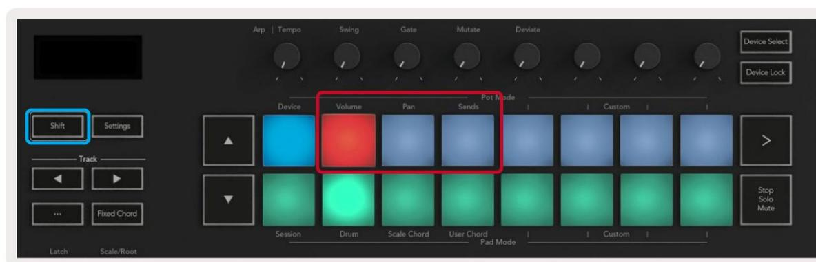
**Volumen:** este modo le permite controlar los volúmenes de las pistas usando los potenciómetros. Para seleccionar este modo, mantenga pulsada la tecla Shift y presione la tecla Volumen.
