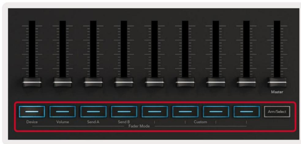
Cuando mueve un potenciómetro o un fader, la pantalla muestra momentáneamente el parámetro y su valor actual. Puede asignar estos modos a potenciómetros o faders en cualquier momento, pero ambos no pueden tener el mismo modo.
