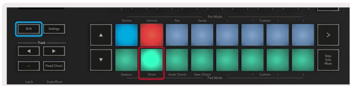
Si se carga un Drum Rack en la pista en vivo seleccionada y su Launchkey está en modo Drum, los pads iluminan el color de la pista. Cuando se reproduzcan, los pads se iluminarán en verde. Estos pads reproducirán cualquier pad de Drum Rack que esté visible en la pantalla de su computadora. Presionando los botones  $\updownarrow$  se desplaza hacia arriba/
