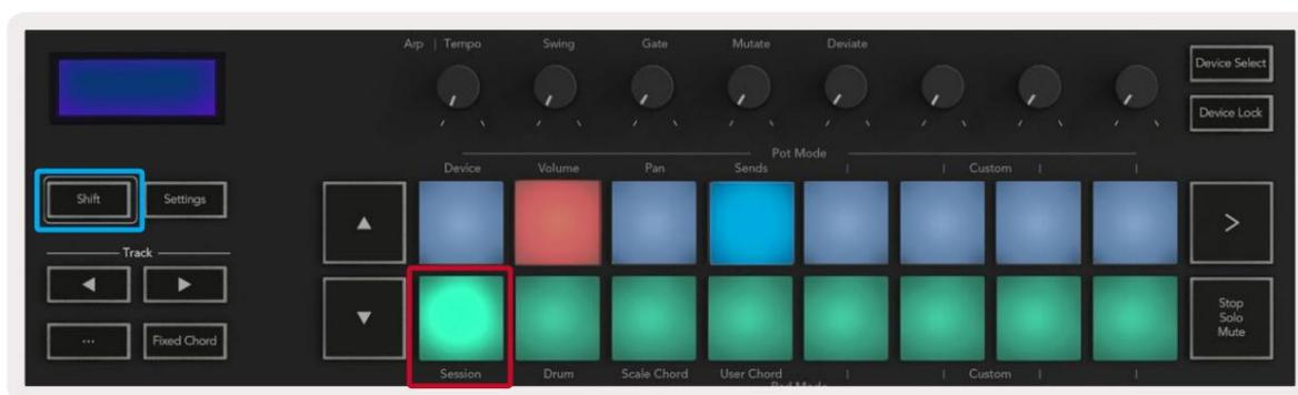
**Modo de grabación/silencio :** la fila superior de pads alterna el brazo de grabación en la pista correspondiente y se iluminará rojo, la fila inferior alterna el silencio de la pista y se iluminará en amarillo. Las pistas representadas por los pads incluyen cualquier pista de envío, la fila superior de pads no se iluminará para los envíos (buses).
