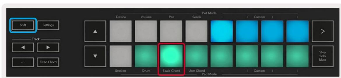
El primer y último pad de cada fila se iluminan más intensamente que los pads del medio para mostrar la posición del acorde fundamental. Para navegar entre las páginas de acordes, use los botones de navegación **ŷŷ**.
