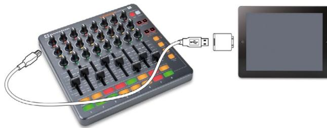
Opomba: Če želite uporabljati Launch Control XL z iPadom, ga morate preklopiti v način nizke porabe. Če želite to narediti, pridržite gumba Uporabniška in Tovarniška predloga ter vstavite kabel USB. Spustite gume Template in pritisnite 'Record Arm'.\* Na koncu pritisnite gumb s puščico desno.
