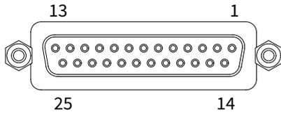
螺丝接线柱使用标准的 UNC 4/40 螺纹
