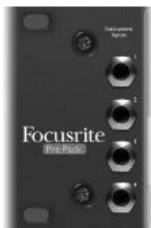
Sorgenti strumentali possono essere connesse solo sul pannello frontale. Sull'estrema sinistra del pannello frontale sono presenti 4 ingressi Strumento su connessioni sbilanciate, numerate da 1 a 4, corrispondenti ad ognuno dei 4 canali. Queste connessioni sono utilizzate principalmente per segnali sbilanciati a basso livello, come per esempio quelli di chitarre e bassi passivi, oppure di strumenti attivi come tastiere e chitarre elektro-acustiche.
