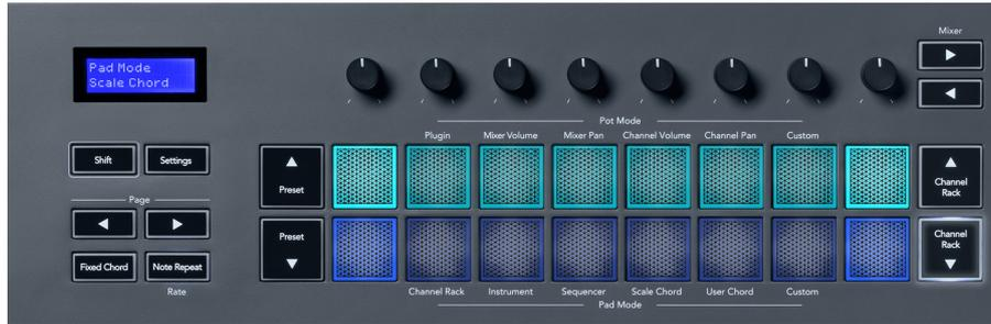
Das erste und letzte Pad jeder Reihe leuchtet heller als die mittleren Pads, um die Position des Grundakkords anzuzeigen. Um zwischen Seiten mit Akkorden zu navigieren, verwenden Sie die Navigationstasten **Seite** ◀ ▶. Dieser Modus hat drei Seiten mit vordefinierten Akkorden: Dreiklänge, 7er, 9er und 6/9tel.
