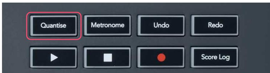
Wenn Sie die Quantisieren-Taste auf FLkey drücken, wird die Funktion „Schnelle Quantisierungsstartzeiten“ in FL Studio ausgeführt. Dadurch werden die Startpositionen aller Noten in der Piano-Rolle für den aktuell ausgewählten Channel-Rack-Kanal auf die aktuelle Piano-Rollen-Snap-Einstellung quantisiert.
