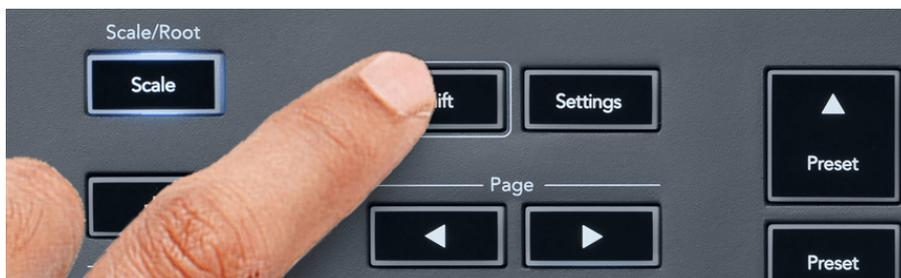
Halte die Umschalttaste (Shift) in einer beliebigen Pad-Anordnung gedrückt, während das Channel Rack von FL Studio sichtbar ist, um die aktuelle Auswahl anzuzeigen. Dies gilt für die Auswahl der Kanalbank, die Steuerung der Drehregler des Channel Rack und die Kanalauswahl. Wenn du einen Mixer-Modus für die Drehregler auswählst, wird die ausgewählte Mischpultbank angezeigt.
