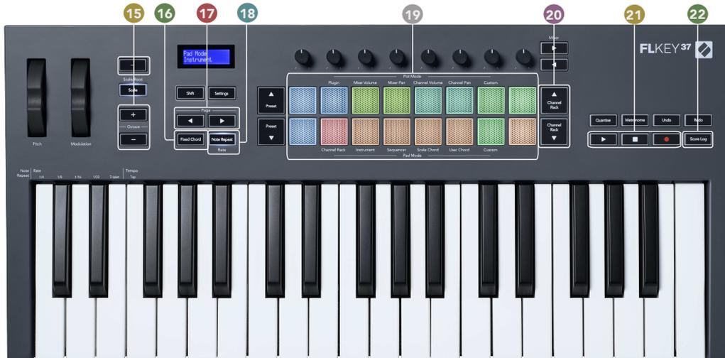
15. **Octave - +/-Tasten** – Transponiert die Tastatur über zehn Oktaven (C-2 bis C6). Wenn Sie beide Tasten drücken, wird der Transponierungsbetrag auf 0 zurückgesetzt. Siehe [Oktavtasten \[33\]](#).
