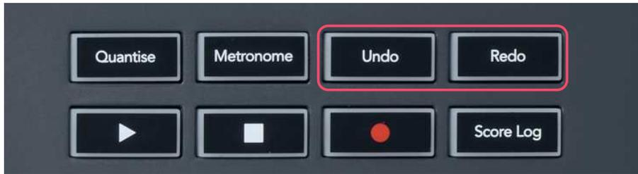
Du kannst die Tasten Undo und Redo auf dem FLkey drücken, um die entsprechenden Funktionen in FL Studio auszulösen. Die FL-Studio-Einstellung "Alternate Undo Mode" hat keinen Einfluss auf die Arbeitsweise dieser Tasten.
