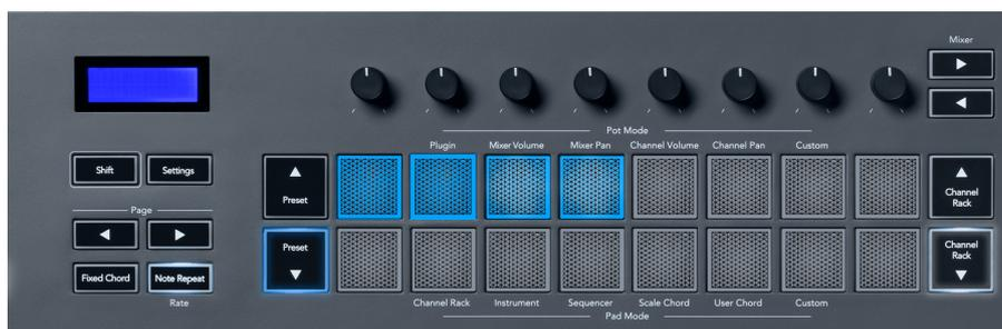
Um eine Akkordzuweisung von einem Pad zu löschen, halten Sie die **Preset**-Taste ▼ gedrückt, die Pads mit zugewiesenen Akkorden werden rot. Drücken Sie ein rotes Pad, um den zugewiesenen Akkord zu löschen. Nach dem Löschen leuchtet das Pad nicht mehr.
