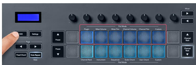
Wenn du in den MIDI-Einstellungen von FL Studio die Funktion "Pickup (Takeover Mode)" aktivierst, muss das Potentiometer zunächst den ursprünglichen Wert erreichen, bevor die Änderungen für den mit dem aktuellen Drehregler verbundenen Parameter gelten.
