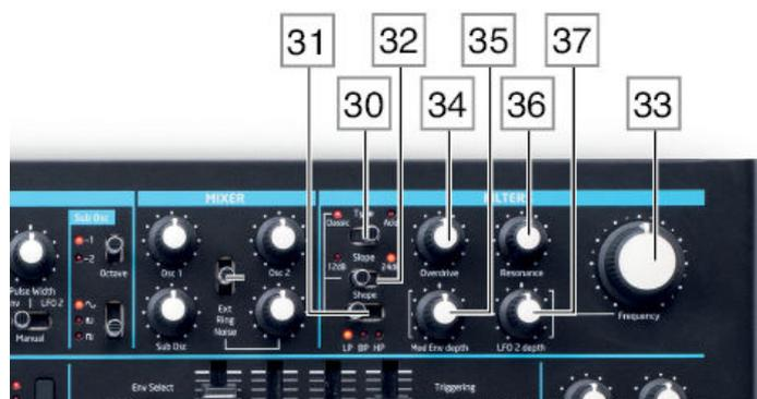
La somme créée dans le mélangeur à partir des différentes sources de signaux est transmise à la section Filtre. Bass Station II La section de filtrage de est à la fois simple et traditionnelle, et peut être configurée avec seulement un petit nombre de commandes à fonction unique.
