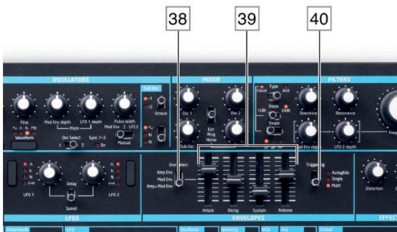
Bass Station II dispose d'un curseur dédié pour chaque paramètre ADSR. Ces curseurs permettent de régler l'enveloppe sélectionnée par le sélecteur d'enveloppe. <sup>38</sup>: l'enveloppe d'amplitude, l'enveloppe de modulation ou les deux ensemble.
