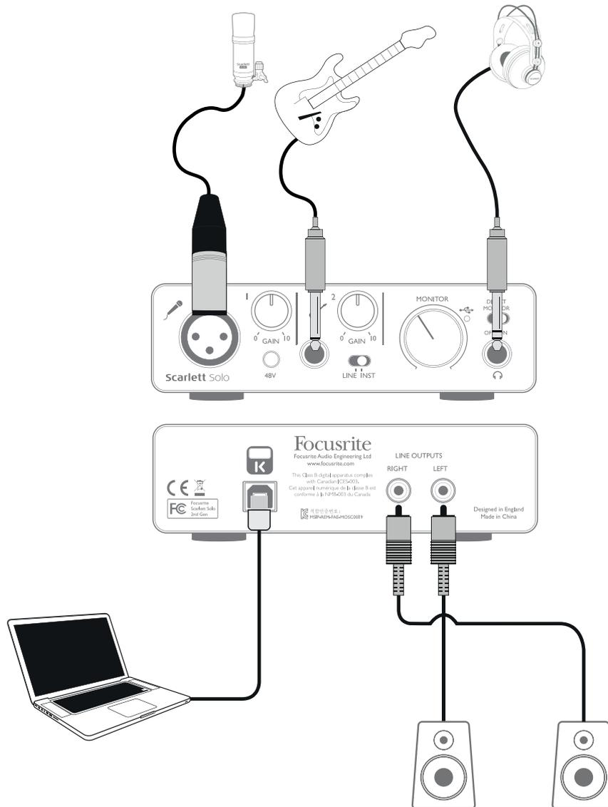
Esta configuración muestra una configuración típica para la grabación con software DAW en su Mac o PC. En este ejemplo, podrá grabar en su aplicación de grabación las voces a través de la entrada 1 y la guitarra a través de la entrada 2 mientras monitoriza la reproducción a través de los auriculares de la DAW.
