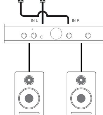
Los conectores de salida de línea son conectores phono (RCA) estándar. Los amplificadores de consumidor (Hi-Fi) y los monitores activos pequeños típicos tendrán entradas en conectores phono (RCA) o vía un jack tripolar de 3,5 mm único (diseñado para la conexión directa a un ordenador). En cualquiera de los casos, use un cable de conexión adecuado con tomas phono (jacks RCA) en un extremo.
