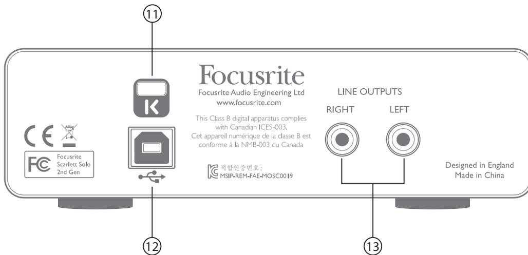
11. K (bloqueo de seguridad Kensington) – asegure su Scarlett Solo a una estructura adecuada si así lo desea. Consulte [www.kensington.com/kensington/us/us/s/1704/kensington-security-slot.aspx](http://www.kensington.com/kensington/us/us/s/1704/kensington-security-slot.aspx) para más información sobre el uso de esta función.
