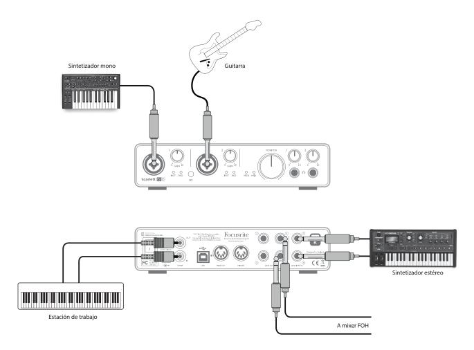
En el ejemplo ilustrado, se han conectado a las seis entradas de Scarlett 6i6 una guitarra, dos teclados estéreos y uno mono; salidas 1 y 2 al sistema PA principal. El artista puede configurar una mezcla aproximada en Focusrite Control y luego retocar los niveles de las dos fuentes mono contra las estéreo desde el panel frontal.
