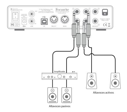
Todos los conectores de salida de línea son tomas jack de ¼" (6,35 mm) tripolares (TRS) y se encuentran balanceados electrónicamente. Los amplificadores de consumidor (Hi-Fi) y los monitores activos pequeños típicos probablemente tendrán entradas no balanceadas, bien en los conectores phono (RCA) o vía un conector jack tripolar de 3,5 mm diseñado para la conexión directa a un ordenador. En cualquiera de los casos, use el cable de conexión adecuado con conexiones jack en un extremo.
