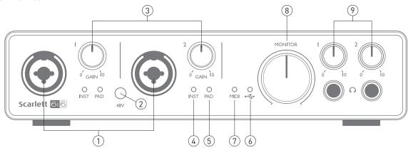
El panel frontal incluye los conectores de entrada para las señales de micrófono, línea e instrumento, los controles de monitorización y ganancia de entrada y clavijas para los auriculares.
