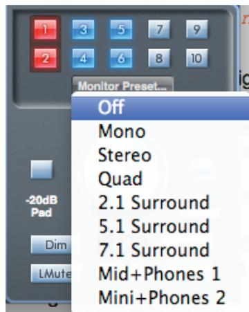
Durch Anklicken der Taste **Monitor Preset...** öffnen Sie eine Einblendliste mit verschiedenen Monitor-Preset-Konfigurationen. Über diese Presets können Sie gebräuchliche Monitor-Konfigurationen schnell und einfach aufrufen. Damit die Monitor-Presets korrekt arbeiten, müssen die Lautsprecher wie in der Tabelle auf Seite 17 dargestellt an den Ausgängen angeschlossen werden.
