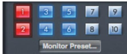
Über diese Tasten wählen Sie aus, welche Line-Ausgänge des Scarlett 18i20 von den übrigen Bedienelementen auf der GUI der Monitor-Sektion und von den Monitor-Reglern auf der Vorderseite bedient werden können. Abhängig von Ihrem Abhör-Setup können Sie wahlweise keinen Lautsprecher, ein einzelnes Monitorpaar oder bis zu 10 Speaker gemeinsam aussteuern.
