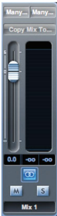
Alle Eingangskanäle werden zusammengemischt und auf den Ausgangskanal des Mixers geroutet. Der Ausgangskanal erlaubt die Aussteuerung der Gesamtlautstärke für die gesamte Mischung. (Beachten Sie, dass es für jeden Mix einen separaten Ausgangskanal gibt.)
