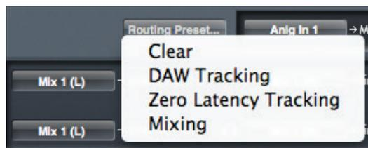
Da Scarlett MixControl extrem flexible Routing-Möglichkeiten eröffnet, können Sie über die Routing Presets individuelle Setups für das Routing und den Mixer anlegen. Mit Hilfe der Presets können Sie Ihr Routing extrem schnell für die Aufnahme (Anhören der Eingänge) oder Mischung (Ausgabe der Signale auf externe Signalprozessoren oder externe Mischpulte) einrichten.
