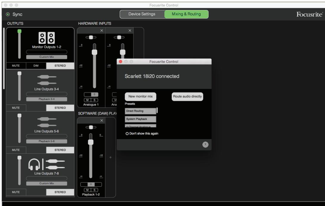
In der folgenden Tabelle ist das Kanal-Routing für das Focusrite Control Preset „**Direct Routing**“ dargestellt; vergleichen Sie dazu den Screenshot auf Seite 19. Beachten Sie, dass die Anzahl der über ADAT realisierbaren Kanäle mit steigender Samplingrate abnimmt und dass bei höheren Samplingraten die Standard-Routingeinstellungen leicht abweichen.
