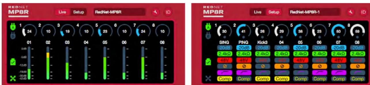
Die obige Abbildung zeigt das RedNet-Steuerungsbild des RedNet MP8R. Die Einstellungen für Signalpegel, Verstärkung und Eingangsfunktion werden für jeden Kanal angezeigt. Verwenden Sie die Live- und Setup-Schaltflächen oben in der Grafik, um die Ansicht zu ändern.
