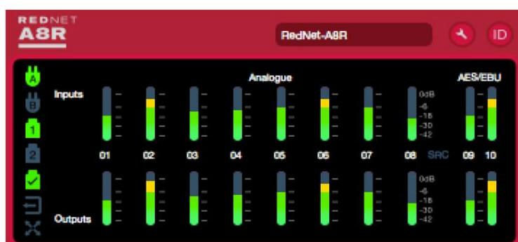
La ilustración anterior muestra un RedNet A8R con señales presentes en todos los canales de entrada y salida.
