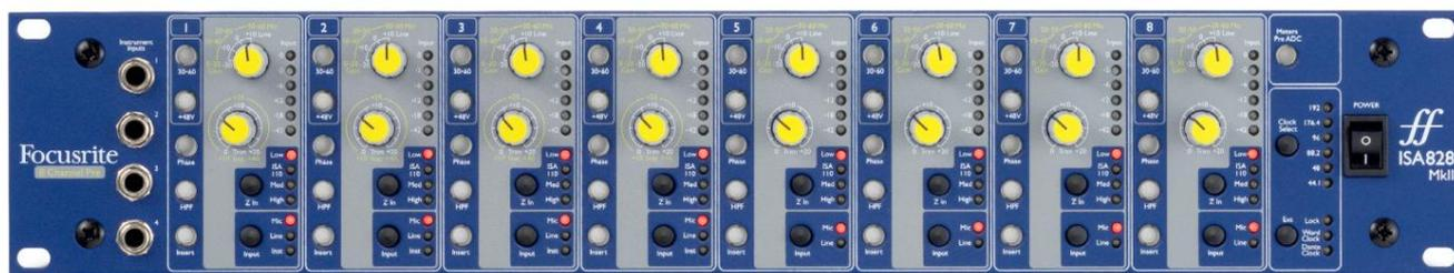
L'ISA 828 MkII è un preamplificatore microfonico a otto canali di alta qualità, che può essere utilizzato per registrare sorgenti microfoniche, a livello di linea o strumentali. I microfoni e le sorgenti a livello di linea per tutti gli otto ingressi sono collegati tramite il pannello posteriore, mentre gli ingressi strumento, disponibili sui canali 1–4, possono essere collegati direttamente alle prese jack del pannello anteriore.
