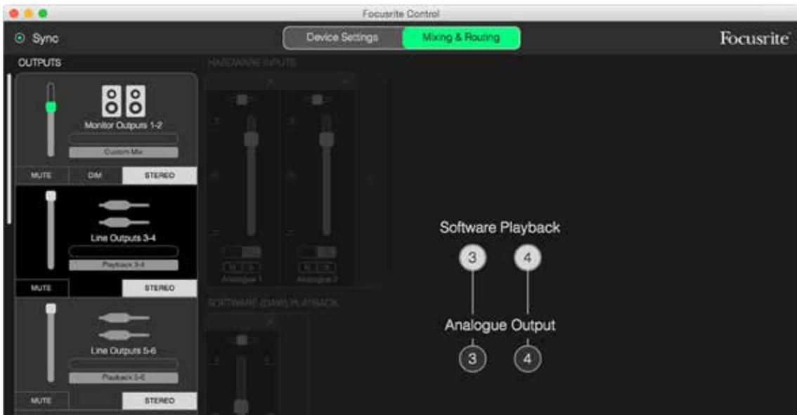
4. **Fader** : utilisez-le pour régler le niveau du signal en sortie. Par défaut, les niveaux de sortie sont tous au maximum (gain unitaire). Si le bouton du fader est vert, cela signifie que la commande de niveau de sortie est affectée à la commande physique **MONITOR** en face avant de l'interface Clarett USB. Cette affectation se fait en page **Device Settings** (Paramètres de l'interface). Consultez la page 26 pour en savoir plus.
