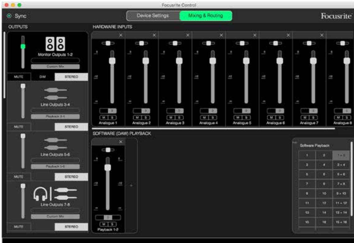
Comme avec le preset 2 Channel Analogue (Analogique 2 canaux), la sommation en sortie de mélangeur est envoyée sous forme de paire stéréo aux sorties d'écoute de contrôle 1 et 2 et aux sorties ligne 7 à 10.
