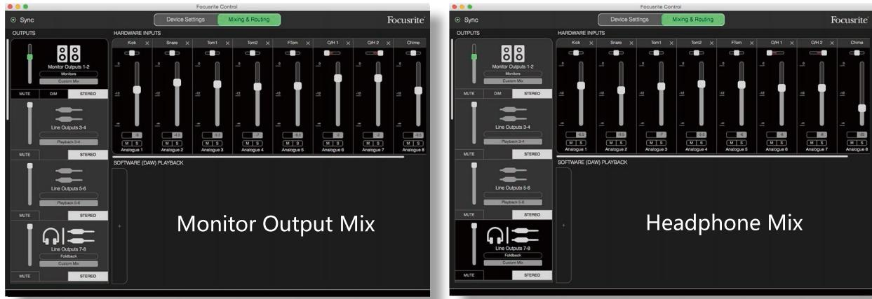
当加载预设时，在耳机输出端的混音和主监听混音是一致的，但它们是相互独立分开控制的。例如：如何你想使用耳机供一个乐手监听，你可能需要设置一个不同的混音。只需为耳机监听选取输出功能框（在Clarett 8Pre USB例子中是线路输出7-8）修改混音即可。同样的原理，你可以通过线路输出功能框，选取定制混音功能进一步为其他乐手创建不同的混音。
