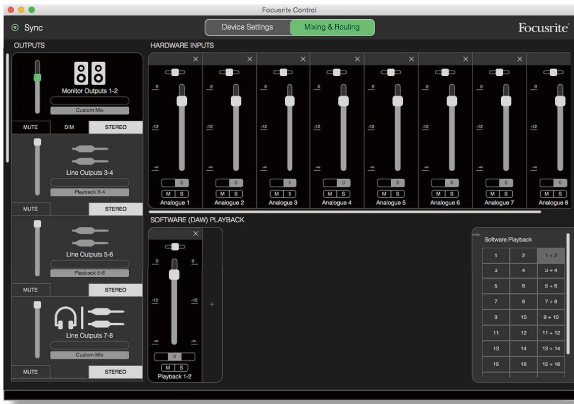
和2通道模拟预设一样，混音的总输出被配置到监听输出1和2；线路输出7-10中作为一对立体声。
