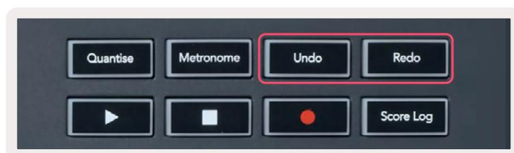
Você pode pressionar os botões Undo e Redo no FLkey para acionar as funções de desfazer e refazer do FL Studio. A configuração do FL Studio "Alternate undo mode" não afeta o funcionamento desses botões.
