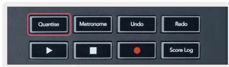
Quando você pressiona o botão Quantise no FLKey 37, ele executa a função 'quick Quantise start times' no FL Studio. Isso quantifica todas as posições iniciais das notas no rolo de piano para o canal do Channel Rack atualmente selecionado para a configuração atual de snap do piano roll.
