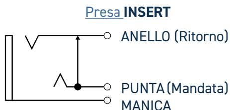
Quando il jack non è inserito nella presa **INSERT**, il percorso del segnale non viene interrotto.
