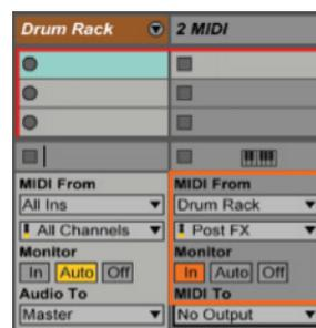
Enfin, dans les sélecteurs « MIDI To », sélectionnez Launchpad Pro Output en haut et Ch. 6 (le canal par défaut du mode User) en bas.
