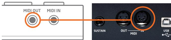
Connexion de la sortie « MIDI OUT » (gauche) du Launchpad Pro à l'entrée « MIDI IN » (droite) de votre appareil.
