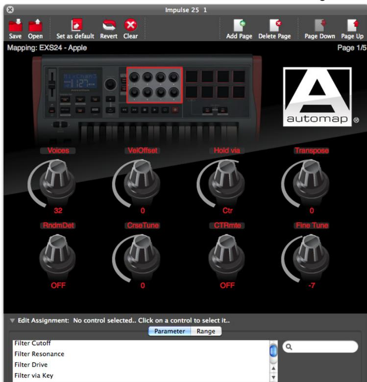
1. Nach dem Anklicken eines Reglers blendet das Fenster Edit Mapping das Bedienfeld Edit Assignment ein (Sie öffnen das Bedienfeld auch durch Anklicken des Pfeils Edit Assignment am unteren Fensterrand). Klicken Sie auf die Parameter-Schaltfläche: Alle verfügbaren Parameter des Plug-Ins werden in der Liste eingeblendet.
