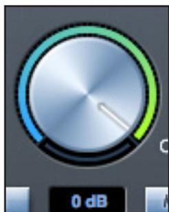
Este control permite ajustar el nivel de salida de todas las salidas asignadas. Utilice el ratón para ajustar el nivel de salida; esto afecta a todas las salidas asignadas (tal y como lo indica el botón azul). El visor dB muestra el ajuste actual del control de monitorización.
