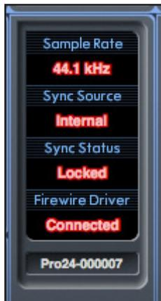
Esta sección refleja el estado de la frecuencia de muestreo, la sincronía y los controladores de la unidad Saffire PRO 24 DSP. Si desea usar la unidad Saffire PRO 24 DSP con dispositivos digitales externos, ajuste la frecuencia de muestreo deseada para la sincronización externa.
