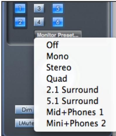
Para que los presets de monitorización funcionen, es necesario tener los altavoces conectados a las salidas de línea, tal y como se muestra en la siguiente imagen.
