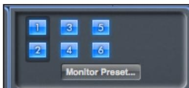
Estos botones indican cuales son las salidas controladas por la sección Monitor en la interfaz gráfica situada justo debajo de los seis botones. La unidad Saffire PRO 24 DSP cuenta con dos niveles de control del volumen de monitorización. El control Monitor del software puede usarse para regular el nivel de hasta 6 salidas al mismo tiempo. Por el contrario, el control Monitor de la unidad regula el nivel de las salidas 1 y 2 (control post-software).
