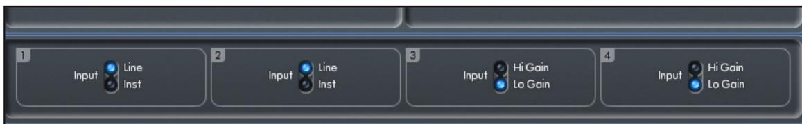
Las señales de nivel de línea adicionales pueden conectarse a las entradas 3 y 4 en la parte posterior de la unidad. La ganancia Pre-amp para las entradas 3 y 4 pueden ajustarse en las posiciones Lo (Low gain; ganancia baja) o Hi (High gain; ganancia alta). Los niveles de entrada máxima antes de la saturación de la señal son:
