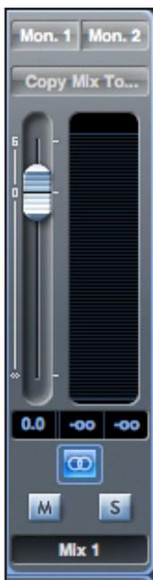
El canal de salida de la mezcla es donde todos los canales de entrada se mezclan entre sí y se envían como una sola señal. El canal de salida permite regular el nivel global de la mezcla. Puede enviar una mezcla a cualquier salida, o a todas las salidas del hardware; si selecciona una sola salida, ésta se mostrará en la parte superior del canal de salida. Si selecciona varias salidas, el visor mostrará "Many..." ("Muchas...").
