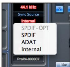
Muestra la fuente de sincronía seleccionada (visor rojo) – Para modificarla, pulse sobre el valor resaltado en rojo y seleccione SPDIF -OPT, SPDIF, ADAT o Internal.
