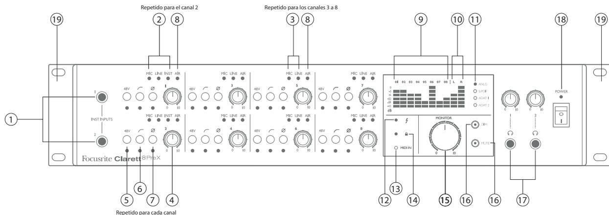
El panel frontal incluye todos los controles de ganancia de entrada y los controles de monitorización, junto con dos tomas de entrada para las clavijas de los instrumentos y dos tomas para auriculares.
