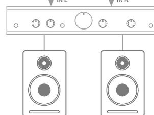
Todos los conectores de salida de línea son tomas de clavija de 1/4" tripolares (TRS) y se encuentran balanceados electrónicamente. Los amplificadores de consumidor (hi-fi) y los monitores pequeños típicos tendrán entradas no balanceadas, bien en las tomas phono (RCA) o vía una clavija tripolar de 3,5 mm diseñada para la conexión directa a un ordenador. En cualquiera de los casos, use el cable de conexión adecuado con las tomas de clavija en un extremo.
