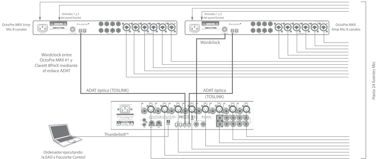
En el ejemplo, los puertos SALIDA ÓPTICA de OctoPre MkIIs están conectados a los puertos ENTRADA ÓPTICA de la Clarett 8PreX mediante dos cables ópticos TOSLINK. A pesar de que las entradas de micrófono se muestran en el diagrama, permitirá cualquier combinación de hasta 24 micrófonos o entradas de línea, algunas de las cuales podrán ser señales de nivel INST.
