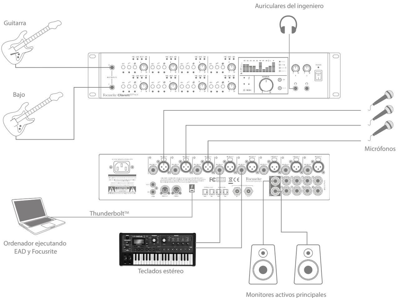
Este ejemplo muestra la configuración típica al grabar multipistas con el software de la EAD en su ordenador.
