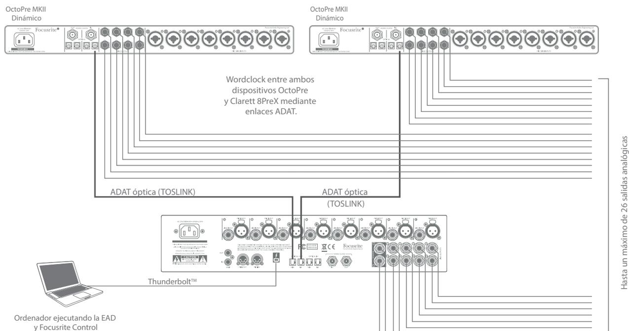
En el ejemplo, los puertos ENTRADA ÓPTICA 1-8 de los dos OctoPre MkII DYNAMICs están conectados a los puertos SALIDA ÓPTICA de la Clarett 8PreX con dos cables ópticos TOSLINK. Las salidas adicionales creadas de este modo podrán enrutarse en Focusrite Control exactamente del mismo modo que con las otras salidas.
