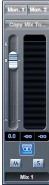
出力チャンネル部は全ての入力チャンネルがルーティングされミックスされる部分です。全体の出力音量を、この部分で設定することができます。
