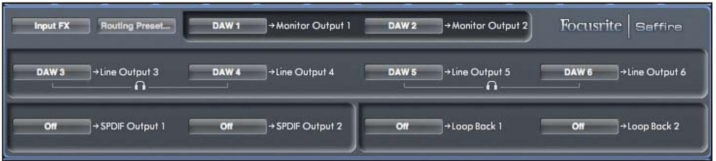
ルーティング設定部を使用して、どの入力ソースをハードウェアの各出力端子に出力するかを設定します。各出力の横に入力ソースを選択できるボックスがあり、クリックするとドロップダウン・メニューに選択可能な出力の一覧が表示されます。
