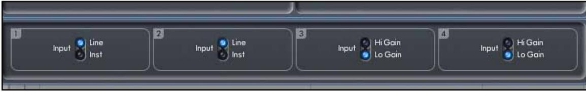
Weitere Linepegelsignale können an den Eingängen 3 und 4 auf der Rückseite des Gerätes angeschlossen werden. Die Vorverstärkung (Gain) für die Eingänge 3 und 4 kann zwischen Lo (niedrig) oder Hi (hoch) umgeschaltet werden. Der maximale Eingangspegel, bevor das Signal übersteuert, liegt bei:
