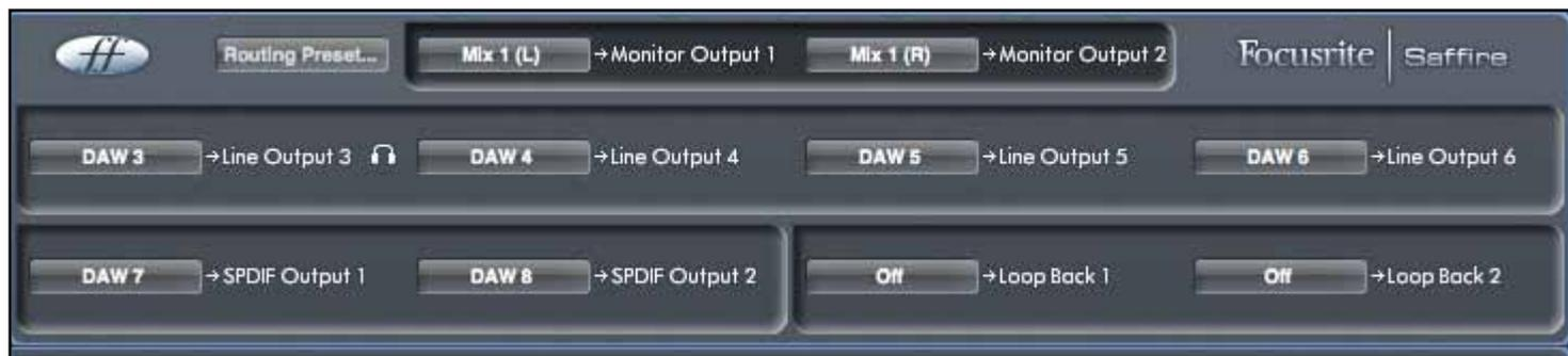
Die Routing-Sektion zeigt jeden Hardwareausgang des Saffire PRO 24. Hier wählen Sie jeweils den Audiodatenstrom, der zu diesen Ausgängen gesendet wird. Nutzen Sie zur Auswahl das Drop-Down-Menü links des jeweiligen Ausgangs.
