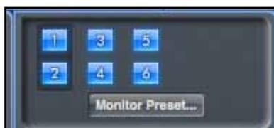
Die Monitor Control Enable Schalter zeigen, welche Ausgänge über die Monitorsektion in der GUI unter den zehn Schaltern gesteuert werden. Saffire PRO 24 kann so konfiguriert werden, dass Sie diese Lautstärkeregelung auch an der Hardware vornehmen können. Abhängig von Ihrem Monitor-Setup können Sie entweder keinen Lautsprecher, ein einzelnes Lautsprecherpaar oder bis zu sechs Lautsprecher gleichzeitig adressieren.
