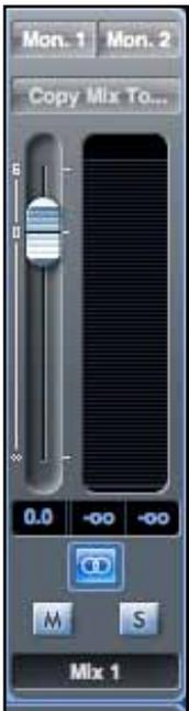
Im Ausgangskanal eines Mixes werden alle Eingangssignale zusammengefaßt und gemischt. Der Ausgangskanal erlaubt die Kontrolle über die Gesamtlautstärke des gesamten Mixes. Ein Mix kann an jeden einzelnen oder alle Hardwareausgänge gesendet werden. Wurde ein Ausgang gewählt, wird dies über dem Ausgangskanal angezeigt, bei mehreren erscheint "many...".
