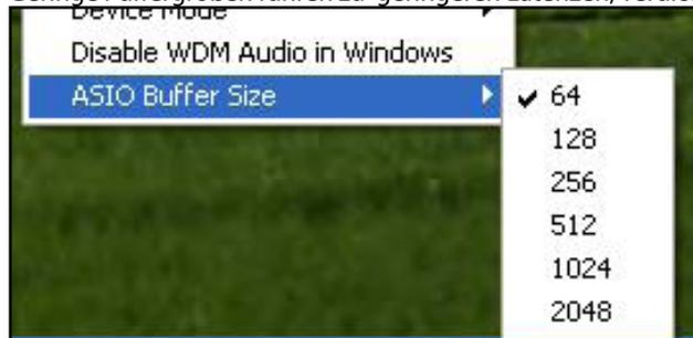
größere Latenz bei geringerer CPU-Belastung. Wenn Sie bei der Verwendung vieler Instrumenten- und Effekt-Plugins in Ihrer DAW eine hohe CPU-Belastung feststellen, können Sie diese durch eine Erhöhung der Puffergröße verringern.
