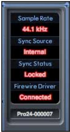
Die Gerätstatus-Sektion informiert über die Abtastfrequenz (Sample Rate), Synchronisation (Sync Source + Status) und Treiber (Driver) des Saffire PRO 24. Die gewünschte Abtastfrequenz kann frei gewählt werden, ebenso die Optionen für die Synchronisation von Saffire PRO 24 mit externen digitalen Geräten.
