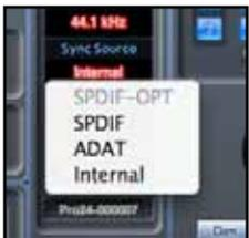
Hier wird die aktuelle Quelle des Syncsignals mit roter Schrift angezeigt. Um die Quelle zu ändern, klicken Sie auf die rote Anzeige und wählen Sie aus folgenden Möglichkeiten: SPDIF -OPT, SPDIF, ADAT oder Internal.
