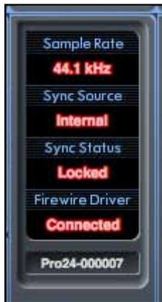
Die Gerätstatus-Sektion informiert über die Abtastfrequenz (Sample Rate), Synchronisation (Sync Source + Status) und Treiber (Driver) des Saffire PRO 24 DSP. Die gewünschte Abtastfrequenz kann frei gewählt werden, ebenso die Optionen für die Synchronisation von Saffire PRO 24 DSP mit externen digitalen Geräten.
