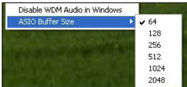
Geringe Puffergrößen führen zu geringeren Latenzen, verursachen jedoch eine erhöhte CPU-Belastung. Eine hohe Puffergröße erzeugt eine größere Latenz bei geringerer CPU-Belastung. Wenn Sie bei der Verwendung vieler Instrumenten- und Effekt-Plugins in Ihrer DAW eine hohe CPU-Belastung feststellen, können Sie diese durch eine Erhöhung der Puffergröße verringern.
