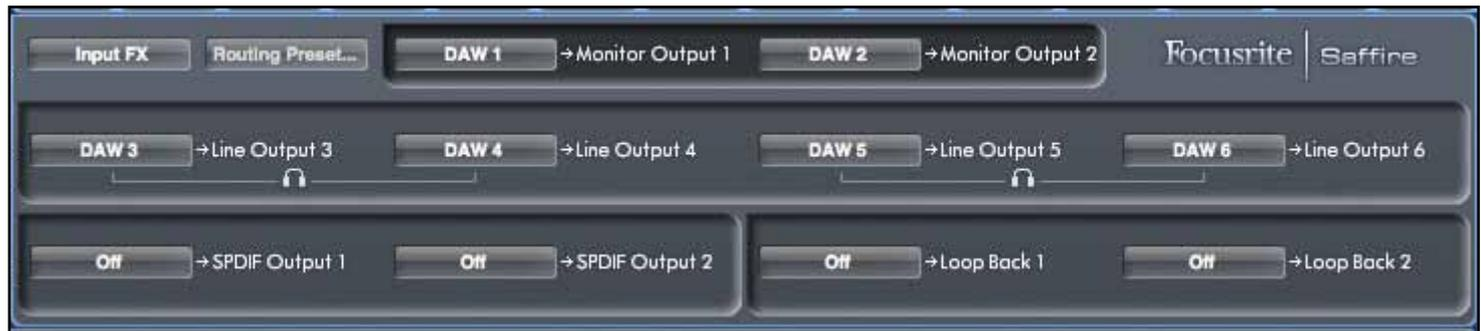
Die Routing-Sektion zeigt jeden Hardwareausgang des Saffire PRO 24 DSP. Hier wählen Sie jeweils den Audiodatenstrom, der zu diesen Ausgängen gesendet wird. Nutzen Sie zur Auswahl das Drop-Down-Menü links des jeweiligen Ausganges.
