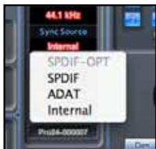
Hier wird die aktuelle Quelle des Syncsignals mit roter Schrift angezeigt. Um die Quelle zu ändern, klicken Sie auf die rote Anzeige und wählen aus folgenden Möglichkeiten: SPDIF -OPT, SPDIF, ADAT oder Internal.
