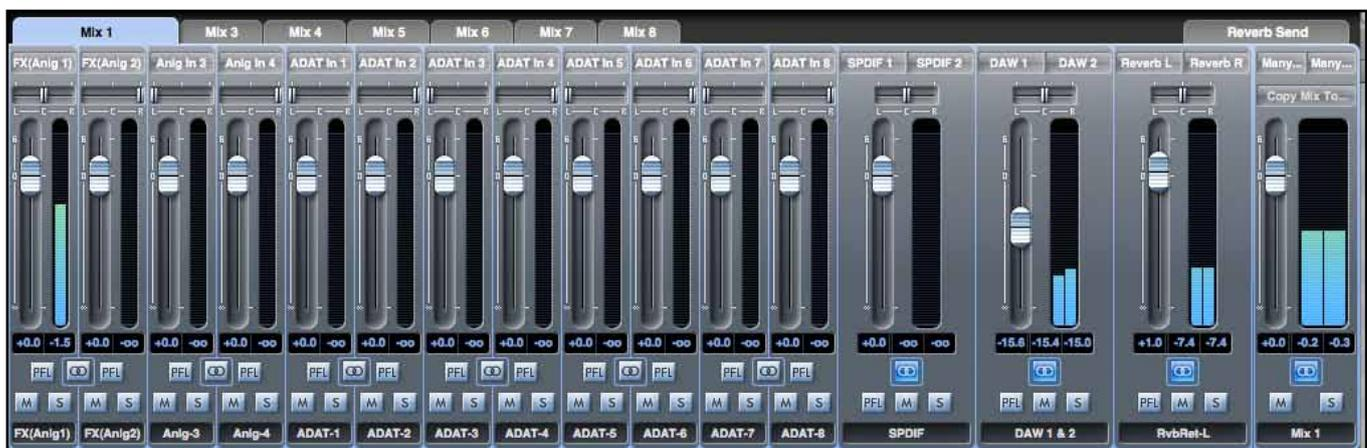
Jeder Mixer (Mix 1-8) verfügt über einen Reverb Return-Kanal.
