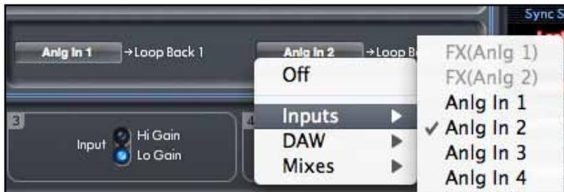
Wenn 'Anlg In 1' und 'Anlg In 2' als Loopback geroutet sind, stehen diese in Ihrer DAW als Loopback-Eingangskanäle für die Aufnahme bereit.
