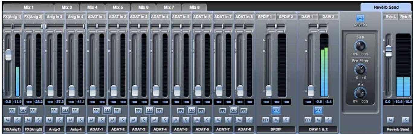
Auf dem obigen Abbildung wird nur Kanal 1 - 'FX(Anlg1)' anteilig an das Reverb gesendet.
