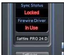
Wenn Audioanwendungen geöffnet sind und den Saffire PRO 24-Treiber nutzen, zeigt der Firewire-Treiberstatus ‘In Use’ an. Verschiedene Einstellungen können währenddessen nicht angewählt werden, sondern erst wenn die Audioanwendungen geschlossen werden und ‘Connected’ als Status wieder anzeigt wird.
