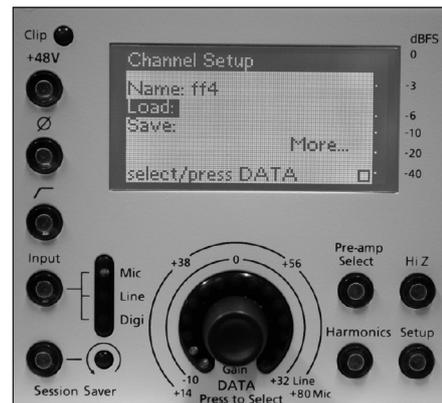
4. Nun drücken Sie den DATA-Regler um diesen Kanalspeicher zu laden. Die Kanaleinstellungen werden geladen und das Display zeigt **loaded ok**:
