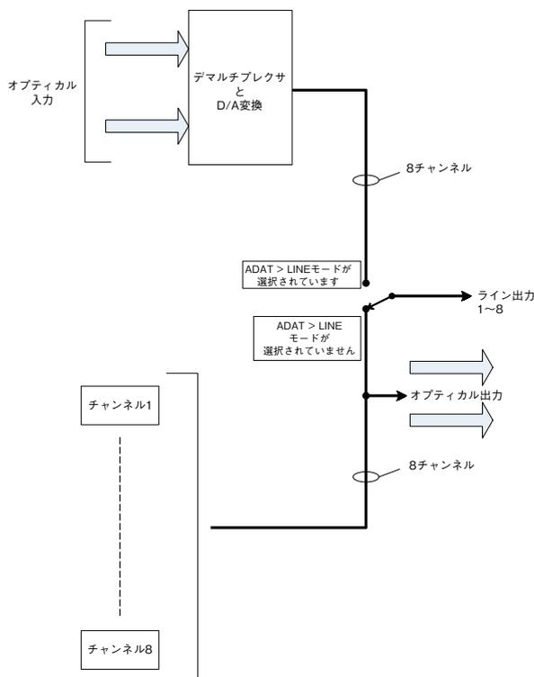
このモードでは、Clarett OctoPre を使用して 8 チャンネルの ADAT フォーマット出力（例：DAW の出力）をアナログミキシングコンソールのチャンネルのようなアナログ入力に接続して、DAWトラックのミックスダウンにコンソールミキサーを使用することができます。
