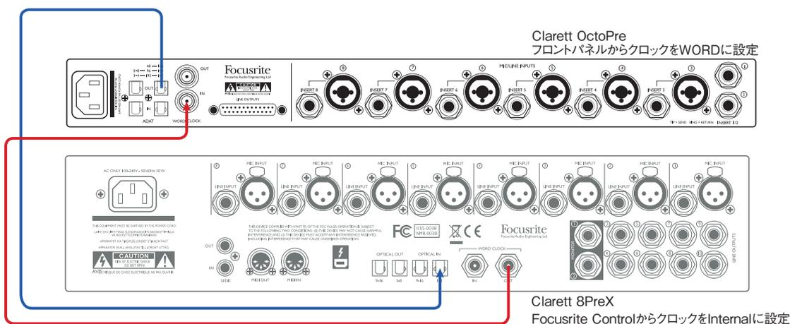
ここでは、一本のオプティカルケーブルで Clarett OctoPre の **OPTICAL OUT** が Focusrite Clarett 8PreX オーディオインターフェースの **OPTICAL IN** に接続されており、どちらの機器も 44.1kHz のサンプルレートで動作しています。OctoPre のクロックソースは WORD に設定されており、その **WORD CLOCK IN** 入力が Clarett 8PreX の **WORD CLOCK OUT** に BNC ケーブルで接続されています。Clarett 8PreX のクロックソースは (Focusrite Control を介して) INTERNAL に設定されているため、同期マスターとして機能します。このセットアップは、ADAT 入力およびワードクロック出力を備えたその他のオーディオインターフェースにも適しています。
