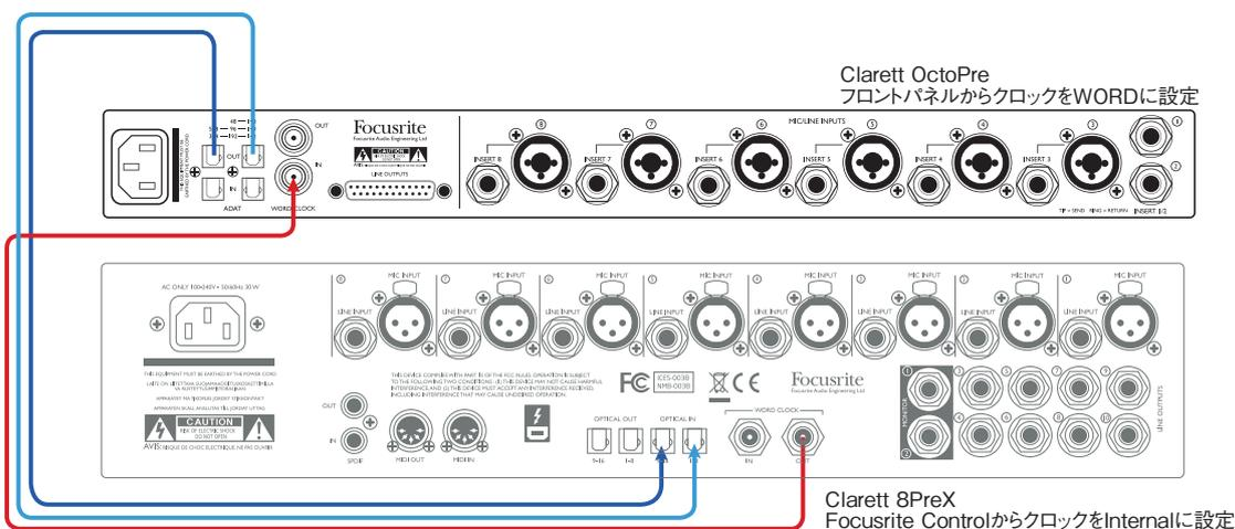
この例では、例 2 と同じセットアップが示されていますが、96kHzのサンプルレート（「SMUX-II」モード）で動作しています。両方の機器を96kHzに設定する必要があります。2つのオプティカルケーブルを使用して、それぞれ4つのオーディオチャンネルを伝送しています。前回の例と同様、Clarett 8PreX が同期マスターとなっています。
