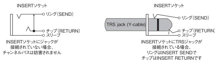
インサートポイントを有効にする場合、フロントパネルの **INSERT/AIR** ボタン [6] を使用します (まずマスタースイッチ [8] で **INSERT** を選択します)。チャンネルの LED が緑色に点灯し、選択を確認することができます。
