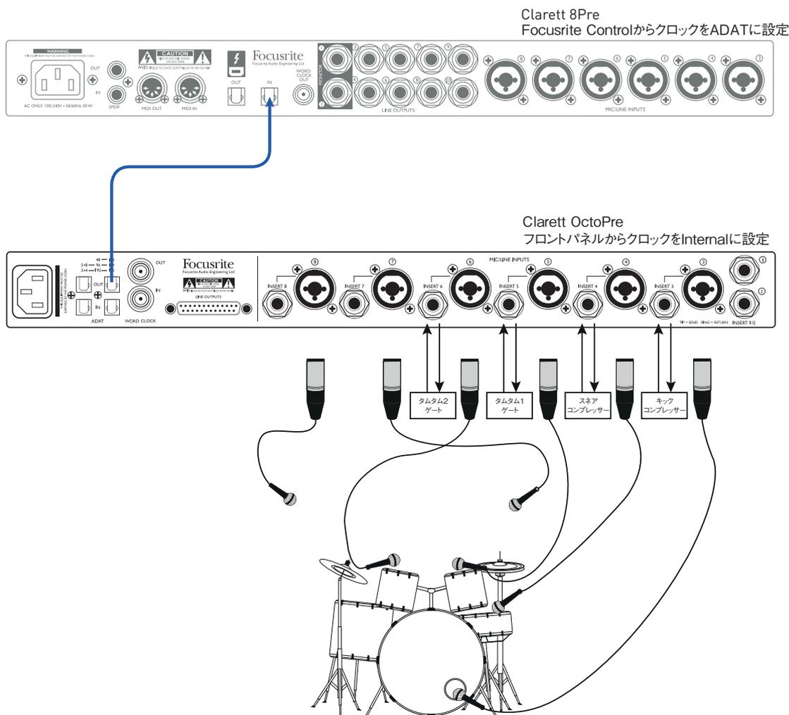
アコースティックドラムのレコーディングを行う場合、希望のサウンドを得るために、様々な方法でダイナミクスに制御を行うことができます。ドラムマイク間の音漏れを最小化するため、タムタムにはノイズゲートが有効になっており、音に厚みを持たせるため、キックとスネアドラムの音にはしばしばコンプレッションが追加されます。
