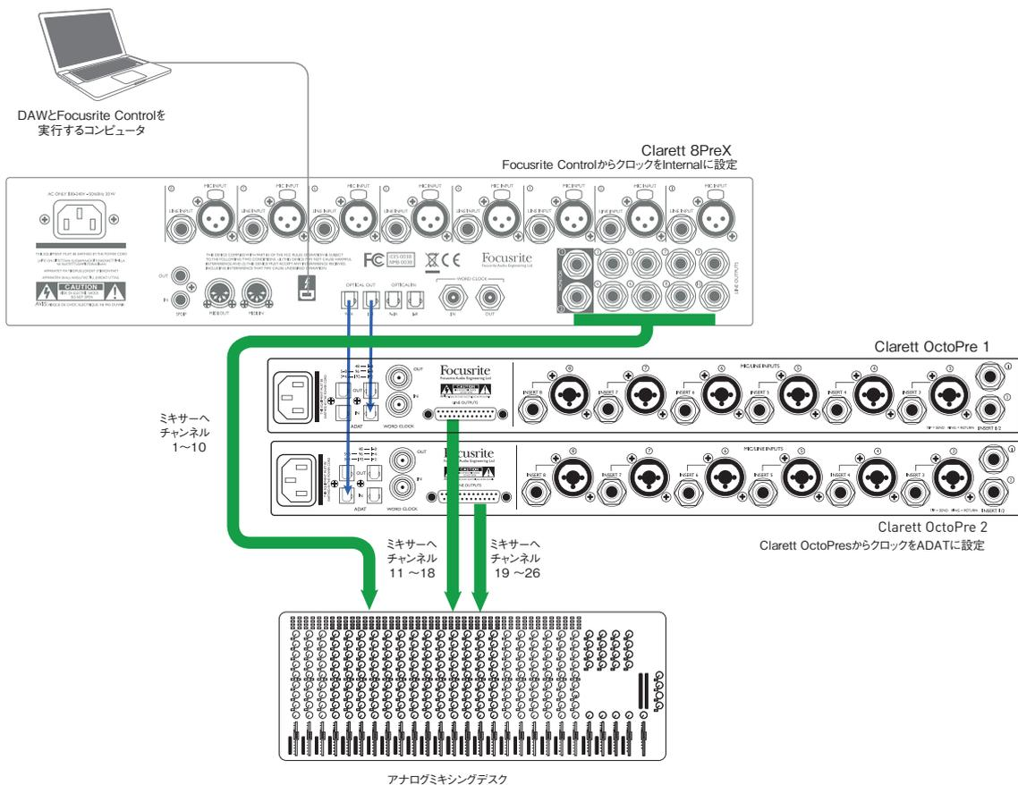
この例では、ミックスダウンの際に数の多い DAW トラックをアナログミキシングデスクに接続する方法を示しており、Clarett 8PreX インターフェースの 10 のアナログ出力がデスクチャンネル 1 ~ 10 に接続されています。そしてその **OPTICAL OUT** ポートは、どちらも ADAT > LINE モードが選択されている 2 つの Clarett OctoPre の **OPTICAL IN** ポートに接続されています。例 4 に使用されているようなスネークケーブルを使用して、2 つの OctoPre をデスクのチャンネル 11 ~ 26 に接続します。
