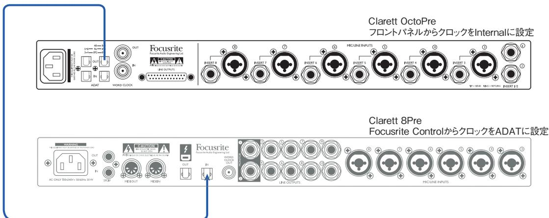
上図では、一本のオプティカルケーブルで Clarett OctoPre の **OPTICAL OUT** が Clarett 8Pre オーディオインターフェースの **OPTICAL IN** に接続されており、どちらの機器も 44.1kHz のサンプルレートで動作しています。OctoPre のクロックソースは INTERNAL に設定されており、8Pre は (Focusrite Control を介して) クロックソースが ADAT に設定されているため、OctoPre と同期が行われています。
