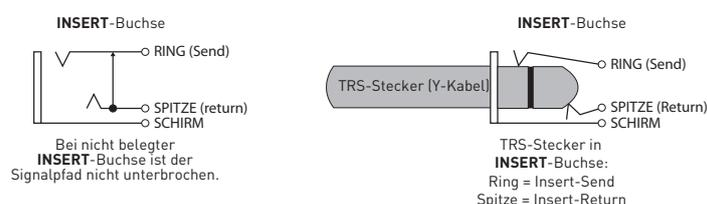
Über die **INSERT/AIR**-Tasten [6] auf der Gerätevorderseite de-/aktivieren Sie die Insert-Wege. (Aktivieren Sie zunächst **INSERT** über die Master-Taste [8].) Die Kanal-LED leuchtet zur Bestätigung grün.
